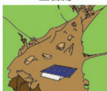
山、川の石や土砂が集中豪雨などによって一気に下流へ押し流されます。スピードが速く、また直進する性質があるので、沢の出口などが危険です。
